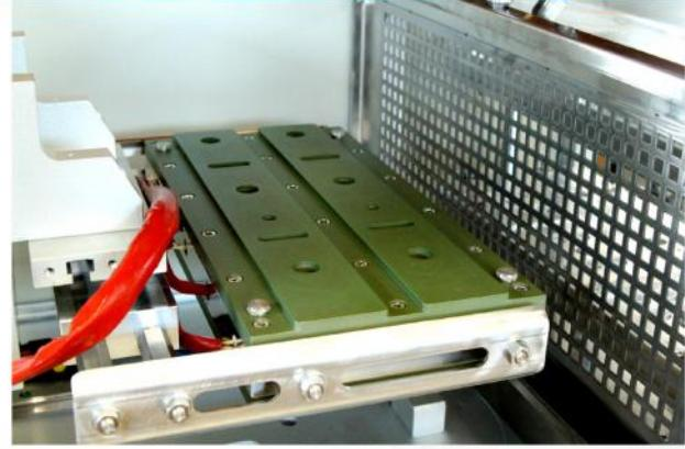
La saldatrice a lama calda Basic ha un cancello che separa la zona di riscaldamento dall'operatore, evitando contatti accidentali. Durante il ciclo di saldatura, questo cancello viene aperto e chiuso automaticamente.
