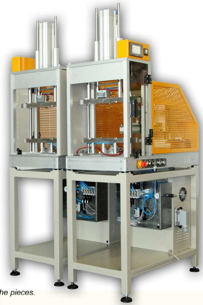
Esempio di saldatrice a lama calda Basic doppia adatta ad essere inserita in una isola con robot per carico/scarico dei pezzi.
