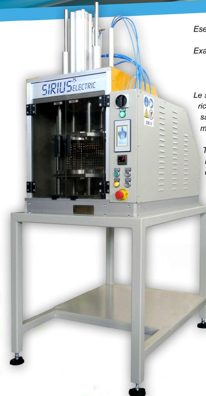
Esempio di saldatrice a lama calda Basic completa di banco di supporto.
