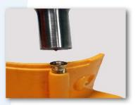
Inserimento di parti metalliche, ribaditure per assemblaggi di parti metalliche con pezzi realizzati in materiale termoplastico, chiusura a punti per imballaggi tipo blister, ribaditure di parti in plastica, sono alcune delle innumerevoli applicazioni che si possono effettuare con un generatore serie US - 400.
